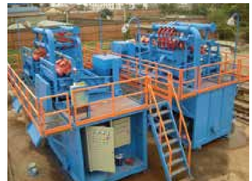
Bild oben: Recycler mit Zwei-Deck-Vibrosieben (Shaker) zur optimalen Abtrennung der groben Feststoffe aus der Bohrspülung.
