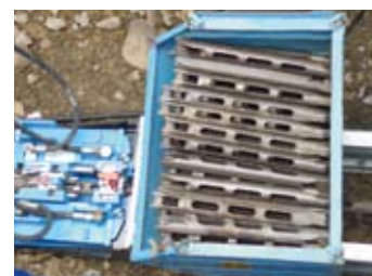
Zásobník tyčí 400S pro tyče: 54 mm Ø, užitná délka 470 mm; nebo tyče: 35 mm Ø, užitná délka 700 mm se 107 tyčemi
