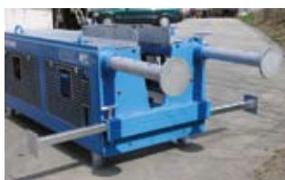
Zásobník tyčí 1250 G pro tyče: 100 mm Ø, Užitná délka: 1700 mm, obsah: 34
