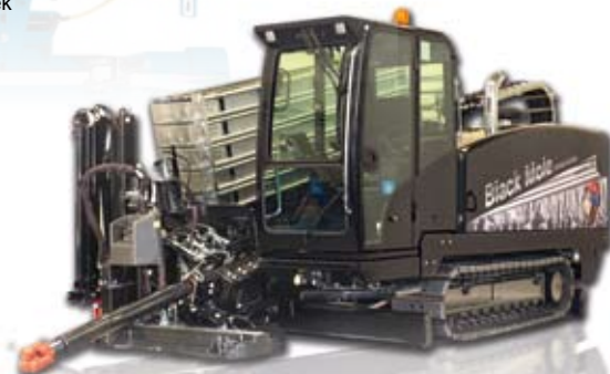
GRUNDODRILL - horizontální zařízení s výplachem 4 - 25 t tlačná a tažná síla, pro pokládku potrubí do Ø 700 mm Typy: 4X, 15XP, 15N und 25N a stroj pro vrtání do skály 18ACS
